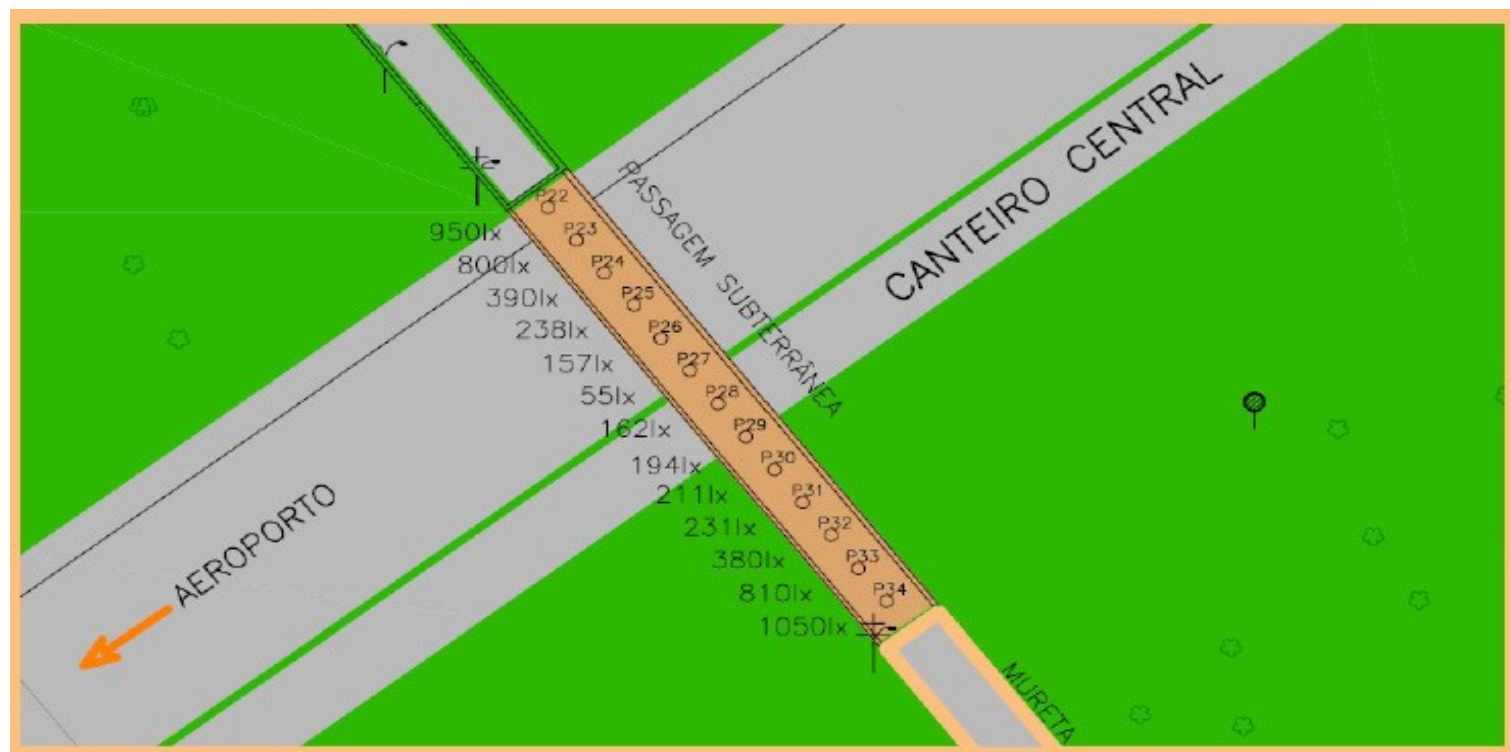
Figura 196. Simulação do projeto do ano 1958 das iluminâncias (lux).
