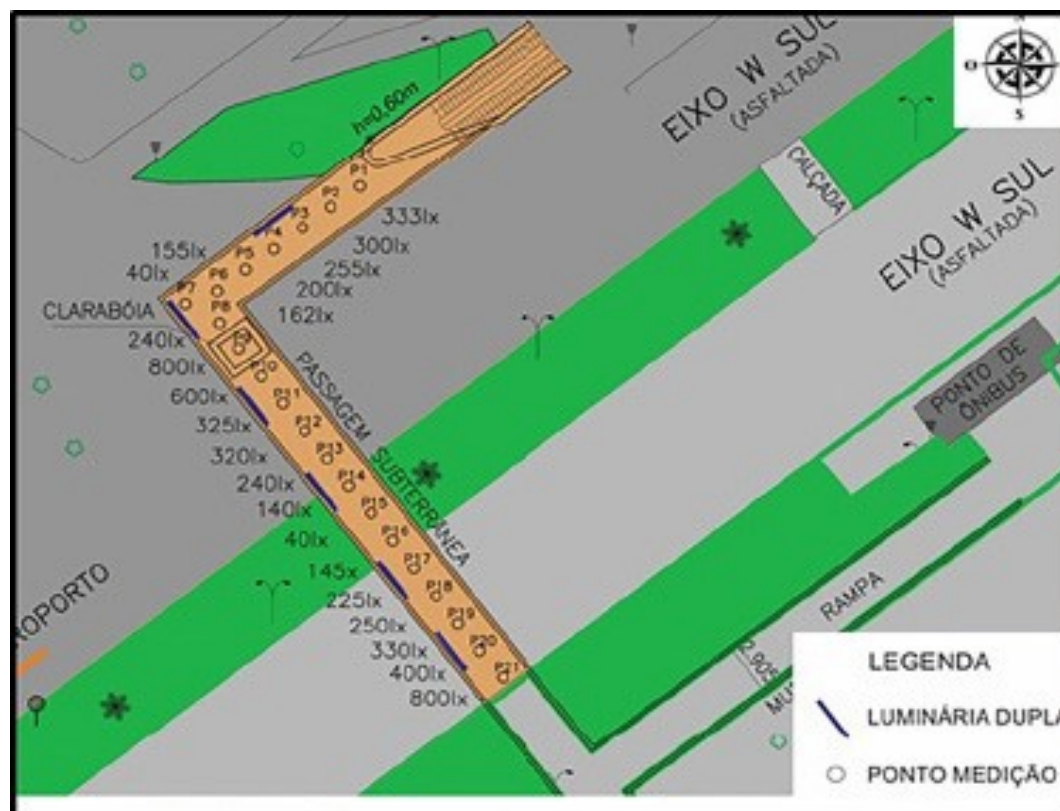
Figura 184. Planta-baixa do trecho estudado da passagem Asa Sul 103-203, com levantamento das iluminâncias (lux) e localização das luminárias (em roxo).
